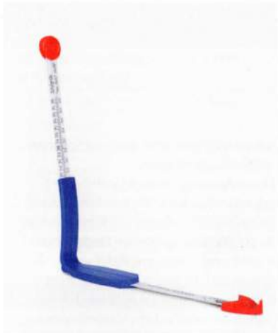
Abb. 2 ▲ Plus12, Messgerät zur Bestimmung der Schuhinnenlänge
