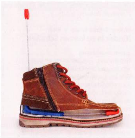
Abb. 2 ▲ Plus12, Messgerät zur Bestimmung der Schuhinnenlänge
